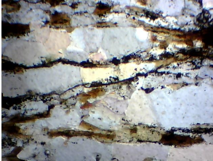
Рис.18. Фрагмент шлифа с микротрещиной в сланце (в центре). Трещина сечёт направление сланцеватости. Размер по горизонтали 1,3 мм
