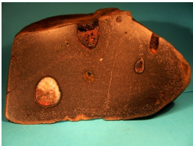
Рис.5. Образец №1, пришлифовка. На фото видно, что материал миндалин выветривается быстрее, чем материал основной матрицы
