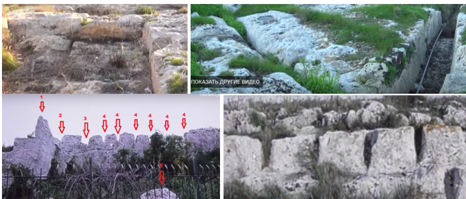
Рис. 14-17 Виды борозды на карьерах. (На рис.16: 1-верхний уровень слоя; 2 - нижний уровень слоя; 3 - борозда, проделанная под очередной слой выемки с косым надколом; 4- борозды, приготовленные для подрыва камня; 5 - добытый камень. На рис.17 справа - борозды на разных уровнях забоя). (Из свободного доступа в Интернете).
