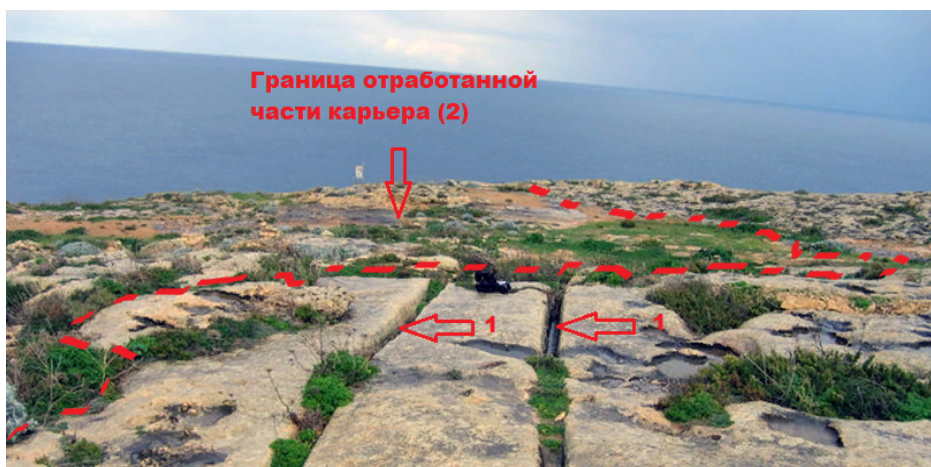
Рис. 10. Разработка карьера. Под №1 борозды для подрыва камня необходимого размера. №2 Граница отработанной части карьера. Мальта. (Из свободного доступа в Интернете).
